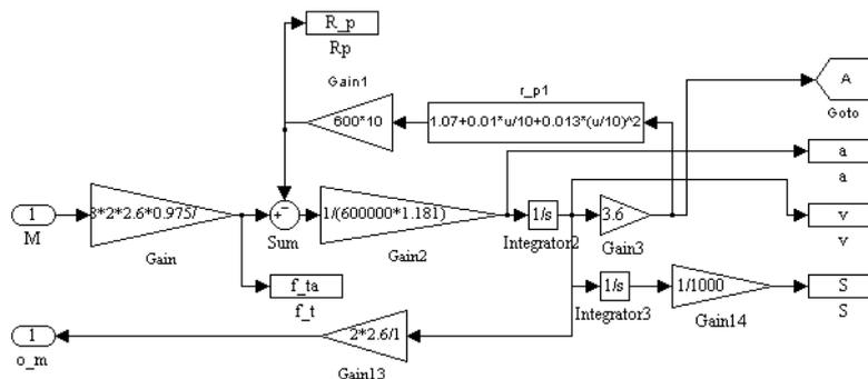
Fig.3 Content of SIMULINK mask block „UM”
