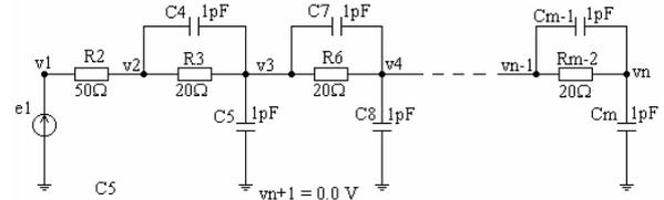
Fig. 1. RC ladder circuit.
