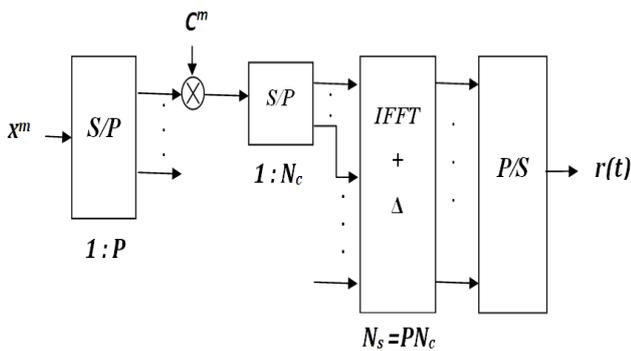
Fig. 1 MC-CDMA Transmitter
