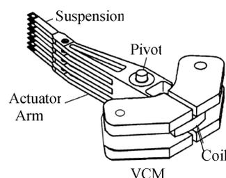
Fig. 1 R/W head-stack [2].
