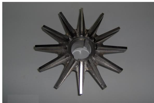
Fig. 8. The centrifugal impeller
