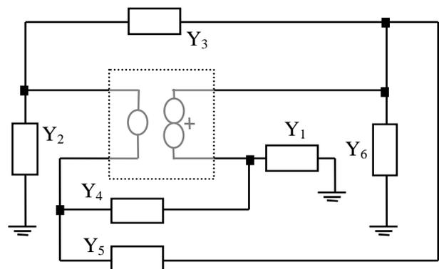
Fig. 8 The oscillator using plus-type nullor [10].
