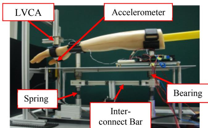
Fig. 1: Hand-arm model rig.
