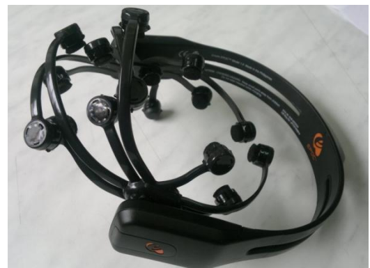
Fig. 7. EPOC Emotiv Interface
