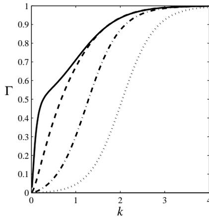
Figure 2: The film parameter  $\Gamma$  vs.  $k$  for  $T = 7.42 \cdot 10^{-4}$  and: (—)  $\delta = 10$ , (---)  $\delta = 1$ , (- · - · -)  $\delta = 0.1$ , and (·····)  $\delta = 0.01$ .
