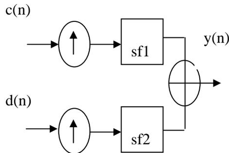
Fig. 2. Separable DWT (Synthesis)
