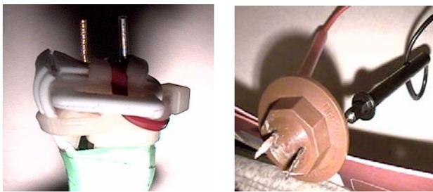
a) Au-Fe Electrodes b) Cu-Fe Electrodes
